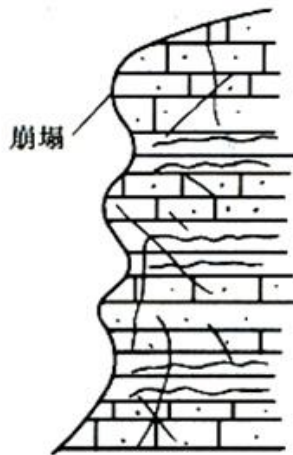
图 4 软硬岩层互层，软岩石风化后使硬岩石失去支持而引起崩塌
